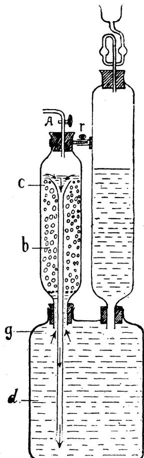
Flasche *d* schlierenförmig auszubreiten. Auf diese Weise entsteht eine Säurezirkulation, dadurch herbeigeführt, dass oben die schwere Salzlösung beständig durch das Trichterrohr abfliesst und dafür bei *g* die spezifisch leichtere Säure in das Gefäss *b* eindringt und hier das Zn bzw. FeS angreift.
