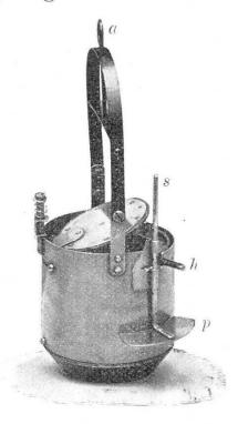
selben. Er besteht im wesentlichen aus zwei Hohlzylindern, einem schweren unteren, scharf in den Schlamm einschneidenden Endstücke, einer obern und einer untern Abschlussvorrichtung, einem verstellbaren Auslöseapparat und einer umlegbaren Aufhängevorrichtung. — Bevor der Apparat an einer starken, oben bei a befestigten Leine in die Tiefe versenkt wird, stellt man die mittels der Stange s verschiebbare Auslösevorrichtung je nach der Höhe der Schlammsäule, die man ausheben
