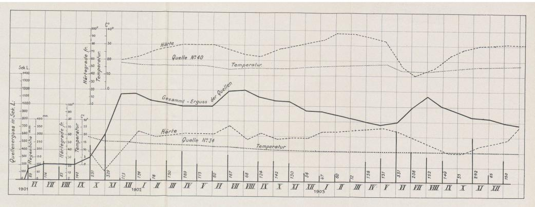
Fig. 11. Schwankungen des Gesamtergusses der kalten Quellen von Iselle zwischen km 3.860 u. 4.421, im Vergleich zur Regenmenge und der Temperatur- und Bärte-Abänderungen
