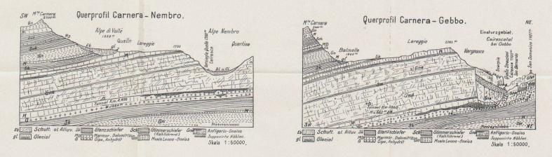
Fig. 12 u. 13. Querprofile durch die wasserführende Zone zwischen km 3.860 und 4.421 des südlichen Engriffs (Jselle)
