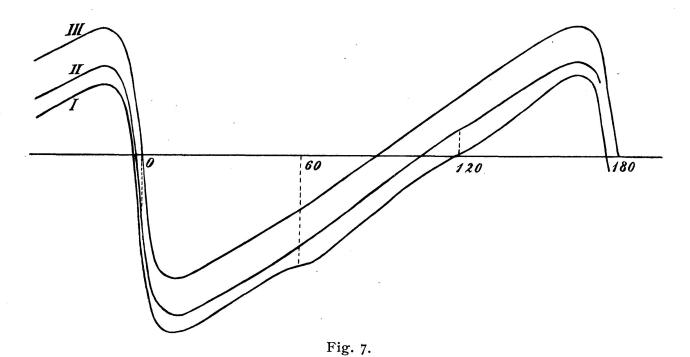
lui imprime que de petites torsions qu'une aiguille mobile au-dessus d'un cercle divisé permet de mesurer. Les déplacements de l'aiguille correspondent donc aux ordonnées des courbes employées ci-dessus. Quand l'aiguille marche rapidement en sens inverse du mouvement de l'aimant, elle décèle, par suite, le passage du minimum d'un des cristaux élémentaires. Nous faisons l'expérience avec des cristaux de diverses compositions.
