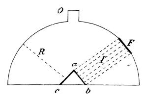
Sur sa périphérie se trouvait une fenêtre en verre F par laquelle passait, en un large faisceau parallèle, la lumière incidente. En regard de cette fenêtre et parallèlement à celle-ci, il s'en trouvait une autre a b qui permettait d'observer la lumière dans la direction du rayon incident. Enfin, pour faire les observations dans une direction perpendiculaire, on disposait d'une troisième fenêtre a c qui laissait passer la lumière diffusée par le liquide trouble dont le vase était rempli.
