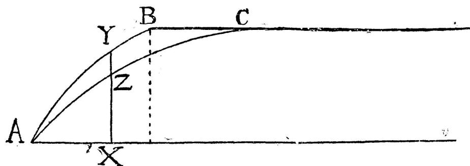
la valeur de l'ordonnée mesurée sera  $xz$ . Cette valeur relative vis-à-vis de  $xy$  indique dans quelle mesure le flux a été ralenti.
