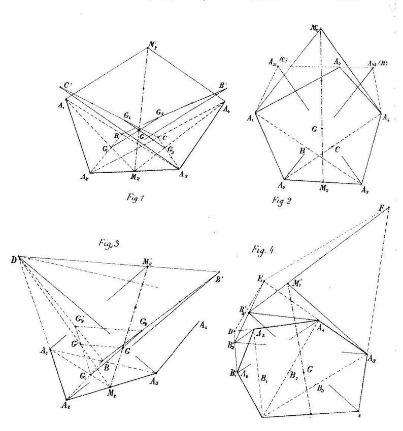
Si donc on mène par les sommets d'un quadrilatère des parallèles aux diagonales on obtient un parallélogramme circonscrit dont les sommets sont les points  $M'_1$ ,  $M'_2$ ,  $M'_3$ ,  $M'_4$ .
