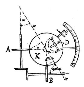
du plan équatorial respectivement celle de l'axe de rotation de la sphère. Mais comme cette position dépend de la vitesse relative des deux disques A et B et de la vitesse relative du nombre d'oscillations de la lame chronométrique, la situation de l'aiguille indique la vitesse de rotation absolue du disque A, par conséquent celle de l'arbre dont la vitesse est à mesurer.
