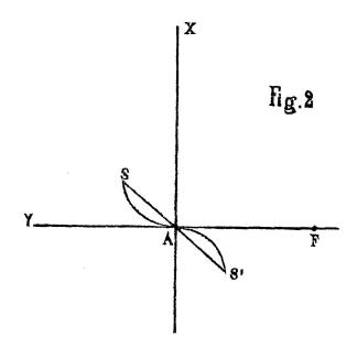
en inclinant MT' au-dessous de MT, x devient négatif et y doit être également négatif, ce qui donne la demi-parabole S' A. Les paraboles correspondant aux diverses valeurs de  $\Delta x$  forment une surface de points matériels limitée extérieurement par SAS', obtenue avec la plus grande valeur. Sur chaque courbe, le point le plus éloigné de A est donné par la valeur maxima de  $tg = \frac{\theta}{2}$ . Admet-
