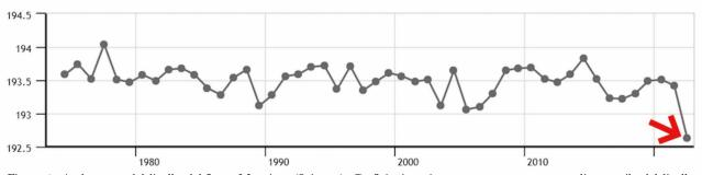
Figura 1: Andamento del livello del Lago Maggiore (Svizzera). Grafici, rispettivamente sopra e sotto, media mensile del livello dell'acqua (WL) dal 2016 in poi e media annuale dall'inizio delle misurazioni nel 1974 espresso in m s.l.m. (m). Evidenziato in rosso (linea e freccia) l'andamento eccezionale del 2022. Dati della stazione misurazione di Brissago (nr. 2074, UFAM 1974-2022 e grafici adattati da OASI 2022).
