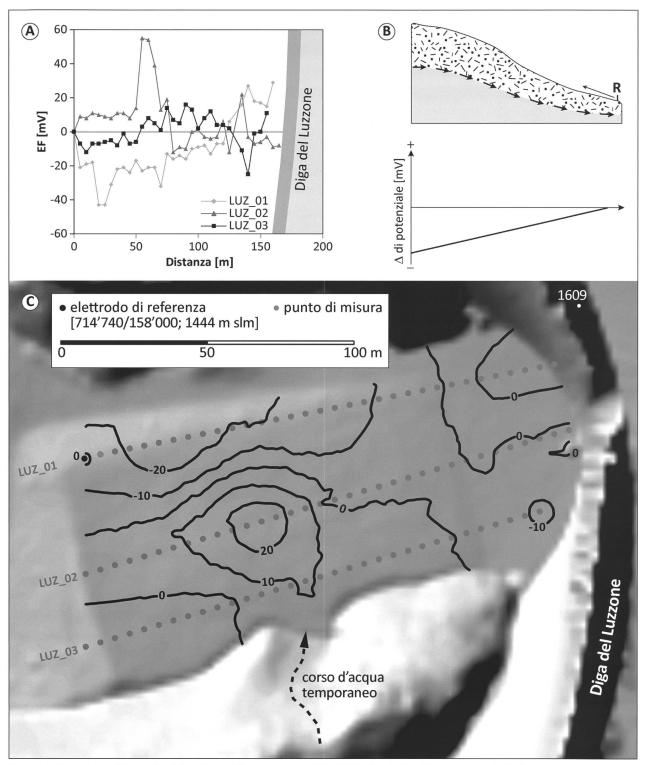
Figura 4: Prospezioni PS a valle della diga del Luzzone, alta Valle di Blenio. A. Profili dei potenziali di elettrofiltrazione. B. Rappresentazione schematica dell'elettrofiltrazione naturale di versante. Modificato da Gass (2003: 10). C. Carta degli equipotenziali di elettrofiltrazione [mV] ottenuta per interpolazione lineare delle misure. Base cartografica: swissALTI3D, ©Ufficio federale di topografia swisstopo.
