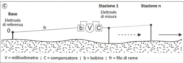
Figura 3: Il metodo della polarizzazione spontanea (PS). A. Struttura schematica dell'interfaccia minerale-acqua all'origine della generazione dei potenziali di elettrofiltrazione. La dimensione del doppio strato elettrico è di alcuni nm. Modificato da Scapozza (2008: 90). B. Materiale utilizzato per le prospezioni PS; nel riquadro, l'elettrodo di referenza. C. Procedura schematica di acquisizione dei dati PS. Modificato da Scapozza *et al.* (2008: 1584).
