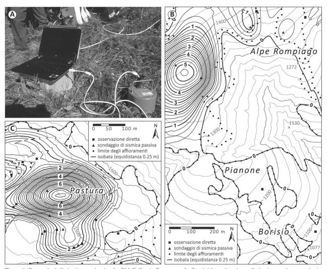
Figura 6: Prospezioni di sismica passiva in alta Val Colla. A. Il tromografo Gemini-2 per le misure di sismica passiva eseguite in questo studio. B. Risultato dell'interpolazione dello spessore del materiale sciolto per il settore dell'Alpe Rompiago. C. Risultato dell'interpolazione dello spessore del materiale sciolto per il settore dell'Alpe Cottino.
