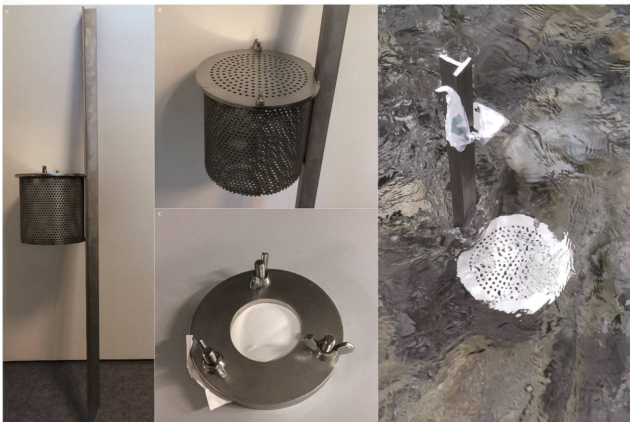
Figura 1: A: Dispositivo di misura per un POCIS; B: cestino in metallo per contenere i POCIS; C: POCIS completo di membrana, pronto all'impiego; D: postazione di misura con POCIS installata in un corso d'acqua.
