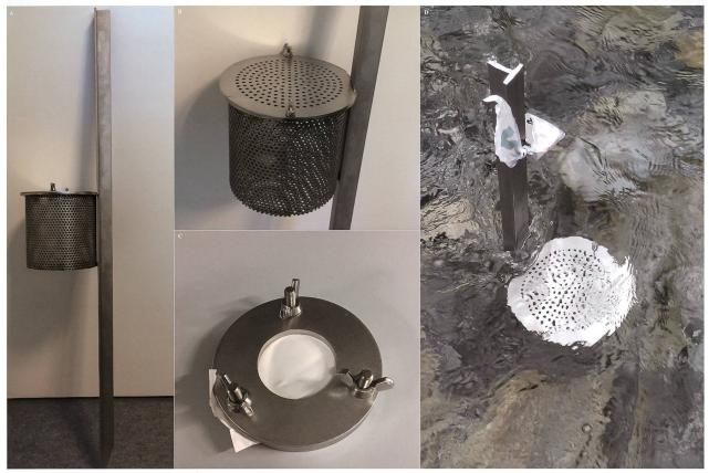
Figura 1: A: Dispositivo di misura per un POCIS; B: cestino in metallo per contenere i POCIS; C: POCIS completo di membrana, pronto all'impiego; D: postazione di misura con POCIS istallata in un corso d'acqua.
