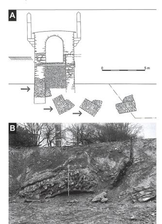
Figura 6: Impatto della Buzza di Biasca sulla Murata a Bellinzona: (A) sezione della Murata e dinamica dei frammenti travolti dalla Buzza di Biasca; (B) frammenti della Murata travolti dalla Buzza di Biasca, visibili nel cantiere dell'Archivio di Stato (1993). Fonte: Donati (1999). ©Archivio Commissione Federale Monumenti Storici (CFMS), Berna.
