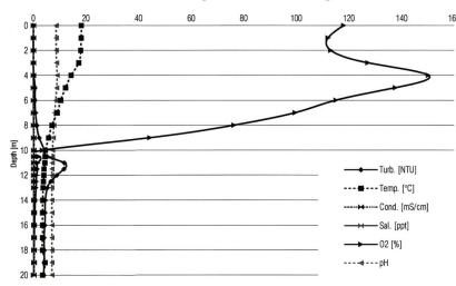
Fig. 2 - Profilo verticale del Lago di Cadagno. I dati acquisiti nel mese di luglio 2010 riportano la variazione dei parametri di torbidità, temperatura, conduttività, concentrazione salina, pH e concentrazione di ossigeno dalla superficie del lago sino al fondale.
