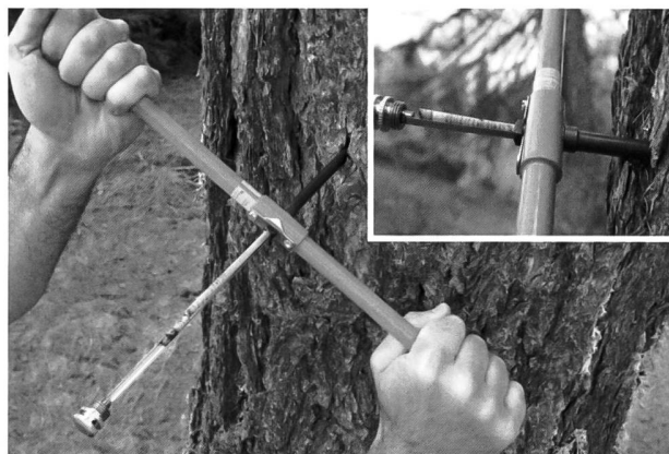
Fig. 5 – Esecuzione di un prelievo con un carotatore o trivella di Pressler (Foto: Patrik Krebs, WSL).
