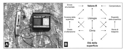
Fig. 2 – (A) Martello di Schmidt con, a sinistra, il percussore che permette di eseguire le misure e, a destra, il modulo digitale di visualizzazione, calibrazione e stoccaggio dei dati misurati (foto C. Scapozza).
