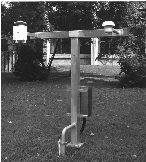
Fig. 12 – Il termohigrometro principale (a sinistra) e quello di riserva (a destra) della stazione SwissMetNet (SMN), in esercizio dalla fine del 2008, in sostituzione delle stazioni ASTA (foto archivio Centro meteorologico regionale).
