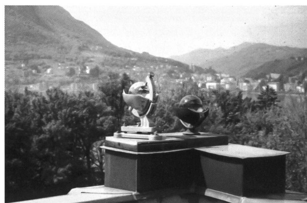
Fig. 6 - Due eliografi (per il rilevamento della durata del soleggiamento) posti sul muretto di cinta della terrazza dell'edificio del Liceo nel 1972. A destra lo strumento prodotto dalla ditta inglese Negretti & Zambra e datato del 1864, a sinistra un modello più recente fabbricato dalla ditta Siap di Bologna (foto archivio Centro meteorologico regionale).
