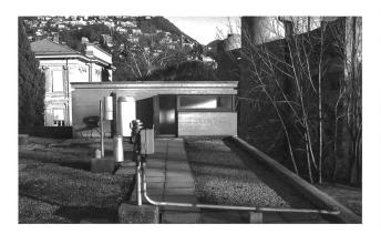
Fig. 10 – Gli strumenti per la misurazione delle precipitazioni della stazione auomatica ASTA, ubicati sul tetto della Biblioteca cantonale. In primo piano è riconoscibile il pluviometro automatico e il rilevatore della radioattività (cilindro piccolo). In secondo piano il pluviometro manuale per le misurazioni di controllo (foto archivio Centro meteorologico regionale).
