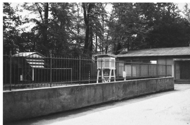
Figg. 8 e 9 – La stazione meteorologica di Lugano nel 1972. La foto a sinistra mostra l'«osservatorio», la capannina Stevenson, il pluviometro e il pluviografo. La foto a destra, ripresa verso sud, mostra invece le capannine Wild (sulla sinistra) e Stevenson (vicino al muro di cinta), e due pluviometri. Oltre il campo di misurazione si riconosce il prefabbricato che ospitava delle aule, in attesa della costruzione del palazzetto degli studi (foto archivio Centro meteorologico regionale).
