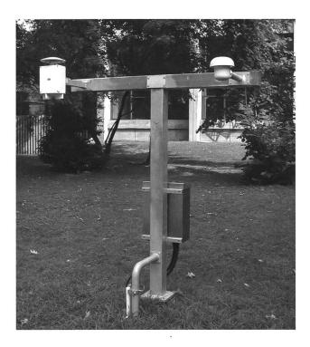
Fig. 12 – Il termoigrometro principale (a sinistra) e quello di riserva (a destra) della stazione SwissMetNet (SMN), in esercizio dalla fine del 2008, in sostituzione delle stazioni ASTA (foto archivio Centro meteorologico regionale).
