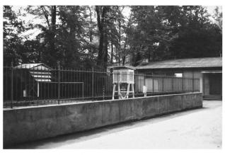
Figg. 8 e 9 – La stazione meteorologica di Lugano nel 1972. La foto a sinistra mostra l'«osservatorio», la capannina Stevenson , il pluviometro e il pluviografo. La foto a destra, ripresa verso sud, mostra invece le capannine Wild (sulla sinistra) e Stevenson (vicino al muro di cnta), e due pluviometri. Oltre il campo di misurazione si riconosce il prefabbricato che ospitava delle aule, in attesa della costruzione del palazzetto degli studi (foto archivio Centro meteorologico regionale).
