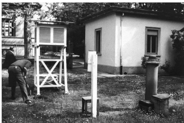
Figg. 8 e 9 – La stazione meteorologica di Lugano nel 1972. La foto a sinistra mostra l'«osservatorio», la capannina Stevenson, il pluviometro e il pluviografo. La foto a destra, ripresa verso sud, mostra invece le capannine Wild (sulla sinistra) e Stevenson (vicino al muro di cinta), e due pluviometri. Oltre il campo di misurazione si riconosce il prefabbricato che ospitava delle aule, in attesa della costruzione del palazzetto degli studi (foto archivio Centro meteorologico regionale).
