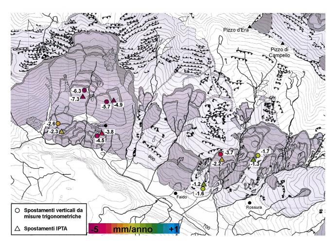
Fig. 10 – Zona di Osco e Faido confronto fra gli spostamenti IPTA e gli spostamenti verticali di alcuni punti misurati con tecniche trigonometriche classiche.
