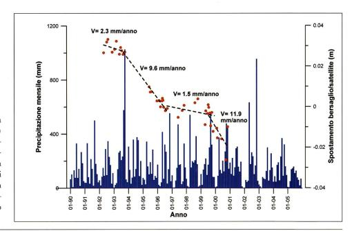
Fig. 7 – Spostamento riferiti alla frana di Lavertezzo (punti rossi) a confronto con le precipitazioni mensili registrate dalla stazione di Frasco (in blu). La linea tratteggiata indica la velocità di spostamento media, espressa in mm/anno. Immagine di riferimento (valore di spostamento nullo) del 15 agosto 1997.
