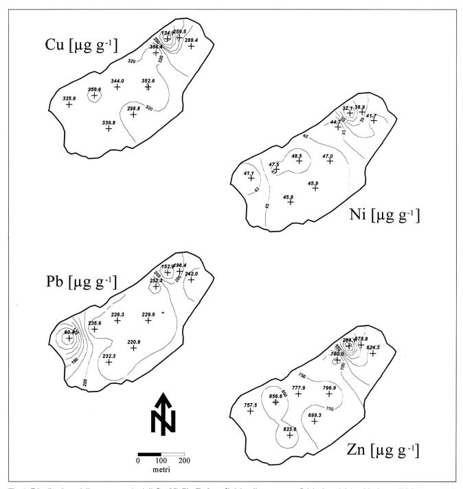
Fig. 2. Distribuzione delle concentrazioni di Cu, Ni, Pb, Zn [µg g¹] del sedimento superficiale (in grigio) nel laghetto di Muzzano stabilita a partire dalle misure effettuate sui campioni (in nero).
