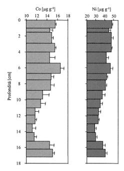
Fig. 3 - Profili delle concentrazioni di cobalto e nichel  $[\mu g \ g^1]$  nei primi 17.2 centimetri di sedimento del laghetto di Muzzano. Le sbarre orizzontali indicano la deviazione standard.
