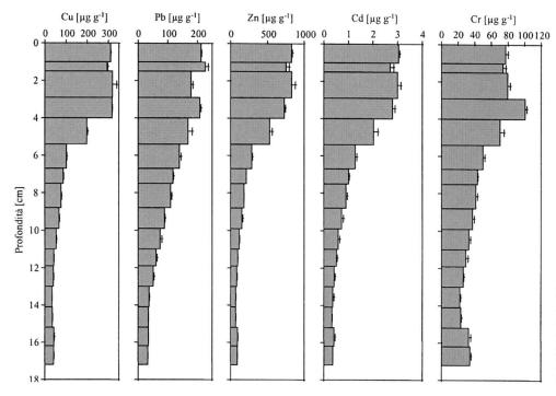
Fig. 4 - Profili delle concentrazioni di rame, piombo, zinco, cadmio e cromo [µg g¹] nei primi 17.2 centimetri di sedimento del laghetto di Muzzano. Le sbarre orizzontali indicano la deviazione standard.
