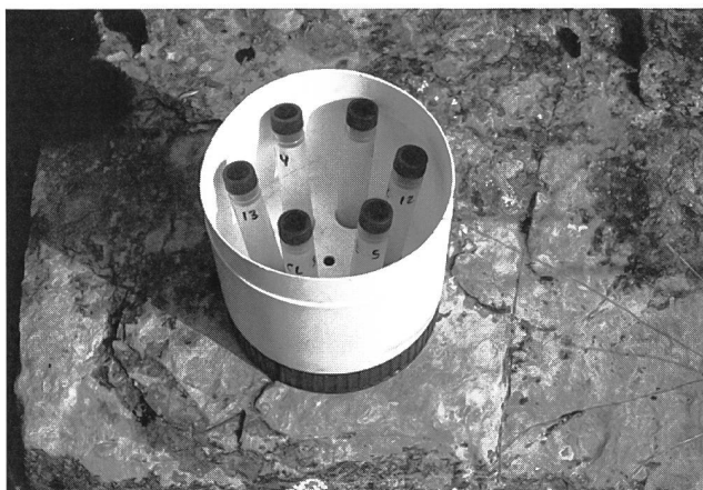
Foto 1. Captori di misurazione di NO 2 .
