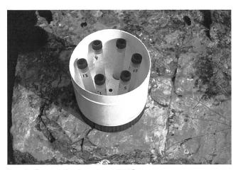
Foto 1. Captori di misurazione di NO<sub>2</sub>.
