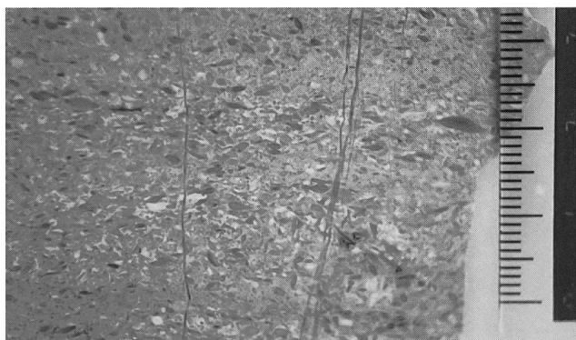
Fig. 3a. Facies B; bioclasti costituenti letti granulo-portanti e successivamente dispersi nella matrice calcarea. Sez. lucida, scala in cm.
