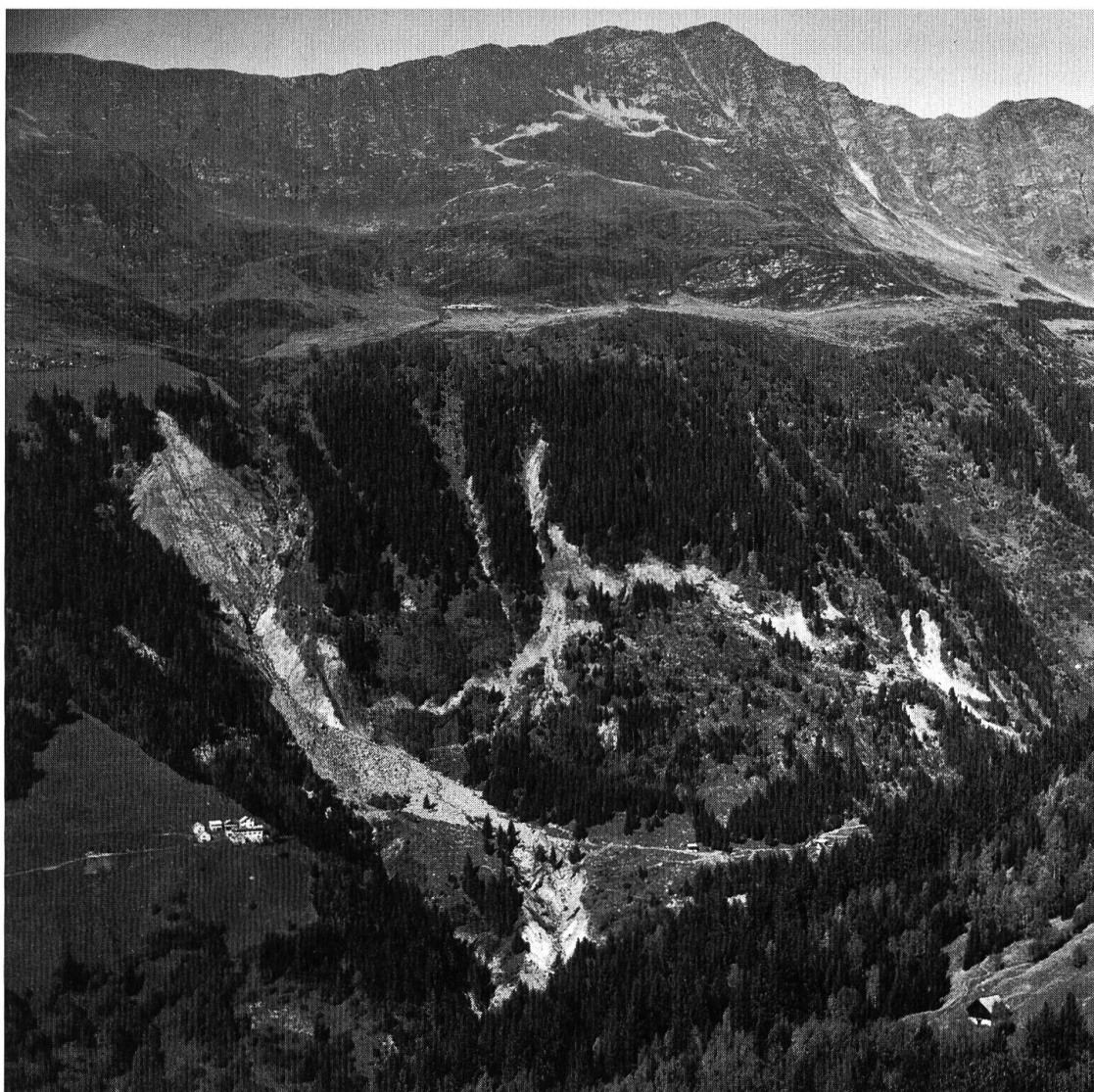
Foto 1: Panoramica del versante destro della Canaria all'altezza di Rùtan dei Sassi. Il nucleo di case di Monti occupa parte del pascolo sulla sinistra (a valle rispetto alla frana). La fessura perimetrale appare come una banda bianca piuttosto sfilacciata. Sulla sinistra si nota il grande affioramento roccioso di forma romboedrica dovuto alla frana del Riale delle Fontanelle. Al centro dell'immagine, verso il basso, è ben visibile l'intaglio prodotto dal Rì di Monti durante l'alluvione del 1993. Sul tutto troneggia il Giübín (2776.4 m). La fotografia è stata scattata da Rùtan (1615 m) nel mese di ottobre 1994. Foto di Roberto Buzzini.
