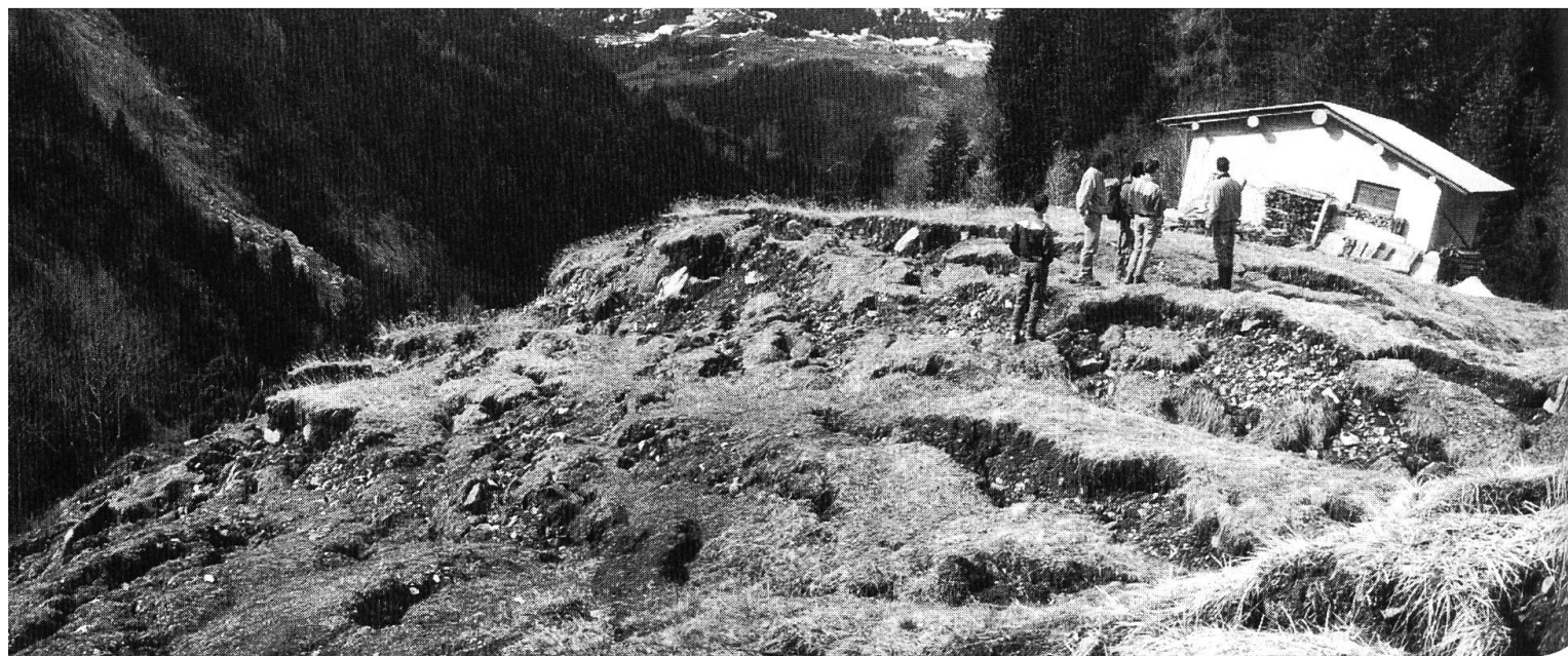
Foto 2: Esempio particolarmente eloquente del tipo di fratture che si creano su di un terreno in movimento. La fotografia è stata realizzata nel mese di maggio del 1993; il 24 settembre 1993 la casa è stata spazzata via da un flusso di detriti causato dall'infiltrazione dell'acqua proveniente dal Rì delle Fontanelle (v. foto 3). Foto di Marco Antognini.
