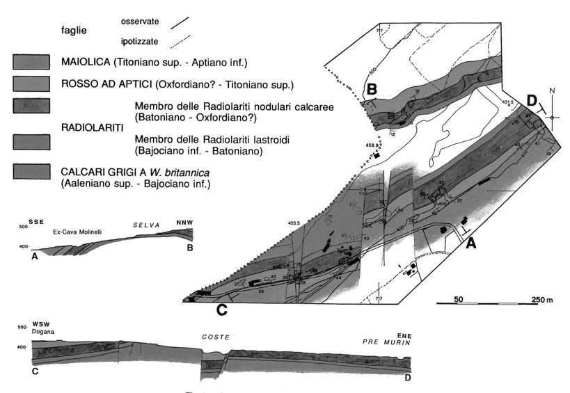
Fig. 3 Carta geologica interpretativa e profili geologici nell' area circostante la Cava Molinelli.
