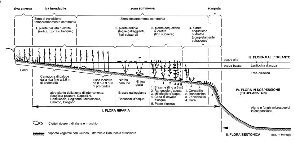
Fig. 3 Sezione attraverso la zona riparia. (mod., da SCHROETER 1932)
