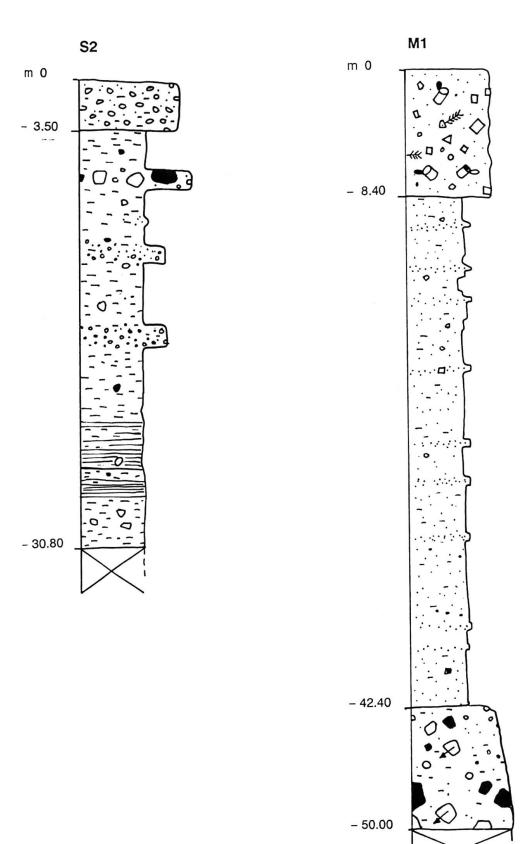
Fig. 16 Sezione stratigrafica del sondaggio S2.
