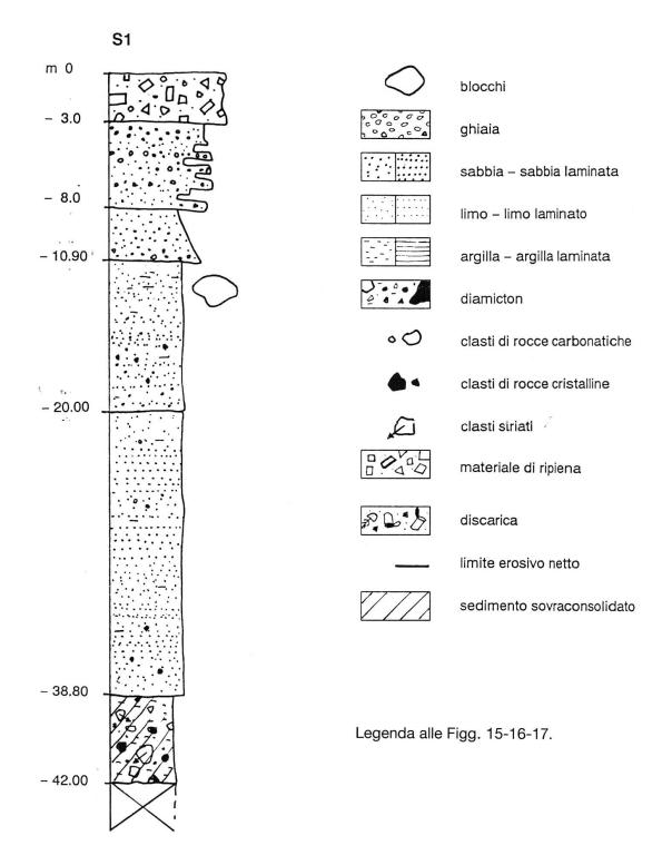
Fig. 15 Sezione stratigrafica del sondaggio S1.
