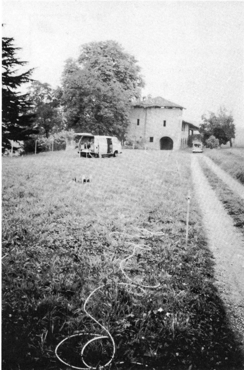
Fig. 3 Rilevamenti geofisici nei pressi della località Loi in Valle della Motta (Novazzano). Al centro la stazione di misurazione, in primo piano i cavi ed i geofoni per il rilevamento dei dati (foto M. Felber).
