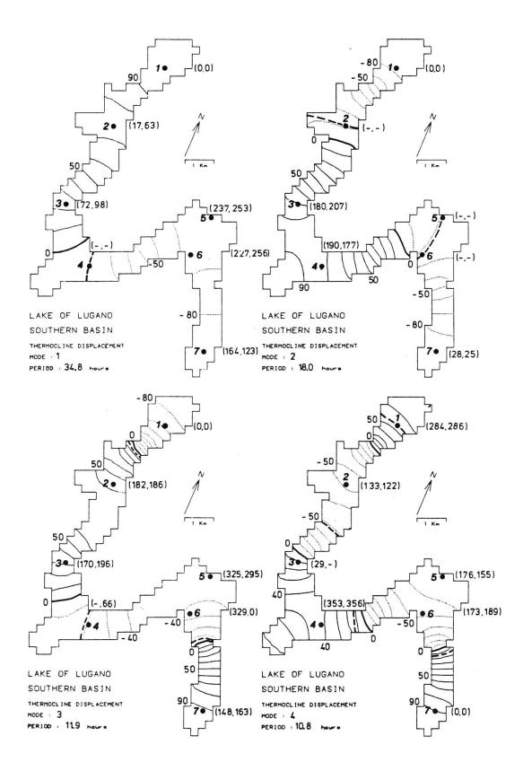
Fig. 6. – Ampiezza relativa calcolata delle onde interne. Le linee in grassetto continue rappresentano le linee nodali calcolate, quelle tratteggiate le linee nodali misurate
