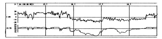
Fig. 14. – Esempio di un evento straordinario in cui il forte vento provoca un passaggio d'acqua profonda dal bacino sud al bacino nord. (Sopra: corrente; sotto: temperatura).
