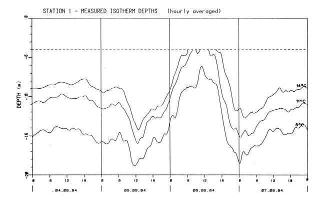
Fig. 9. - Spostamenti misurati delle isoterne dopo una tempesta
