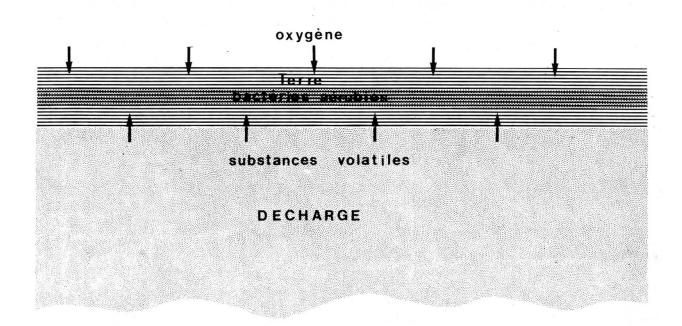
Fig. 5. - Schéma d'une coupe à travers la couche de terre recouvrant une décharge, matérialisant l'interface entre l'air et les substances volatiles formées dans la zone anaérobie.
