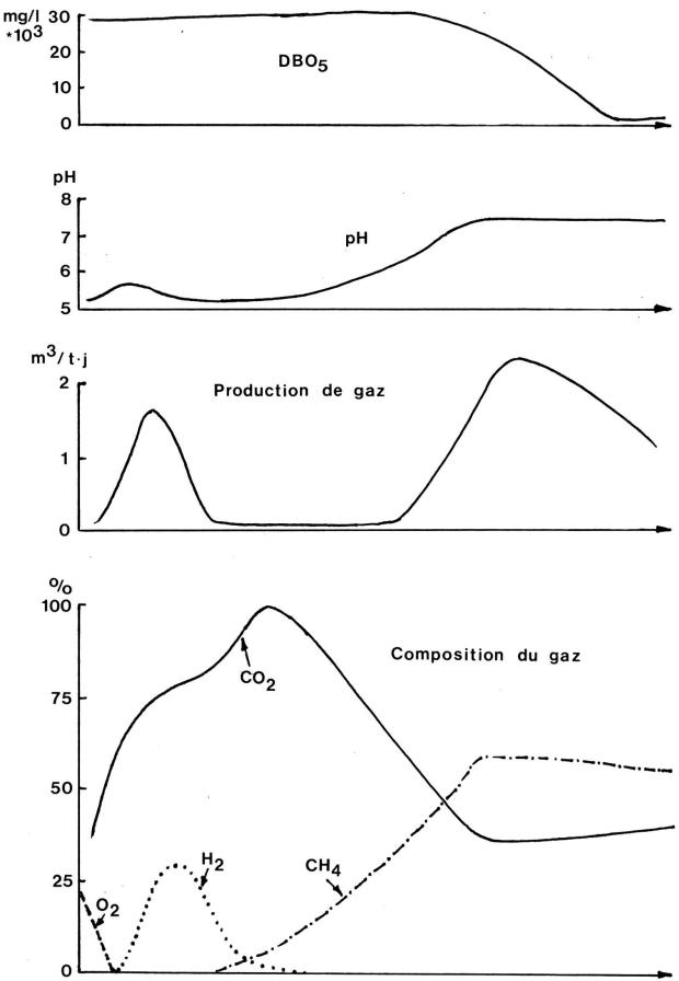
Fig. 5. - Diagramme de l'évolution des émissions gazeuses et liquides dans une décharge controlée. L'échelle de temps est arbitraire.
