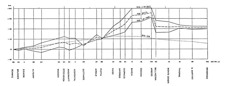
Fig. 1. - Sollevamento lungo il profilo Schwyz-Gottardo-Mendrisio calcolato a partire da tre livellazioni di precisione 1869/1872, 1919 e 1970. KOBOLD, 1970
