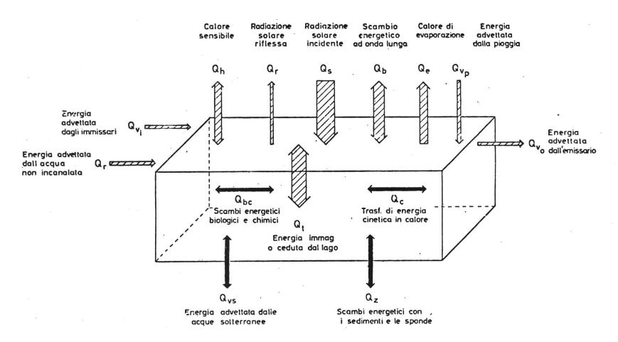
Fig.2 - Schematizzazione di un bilancio di calore (da Barbanti 1976)
