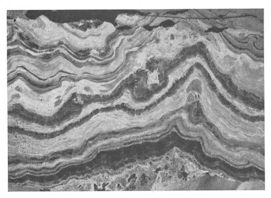
FIG. 1: Aragonite concrezionata in strati concentrici di colore variabile — esemplare segato e lucidato. Giac. di Gravesano - Manno.
