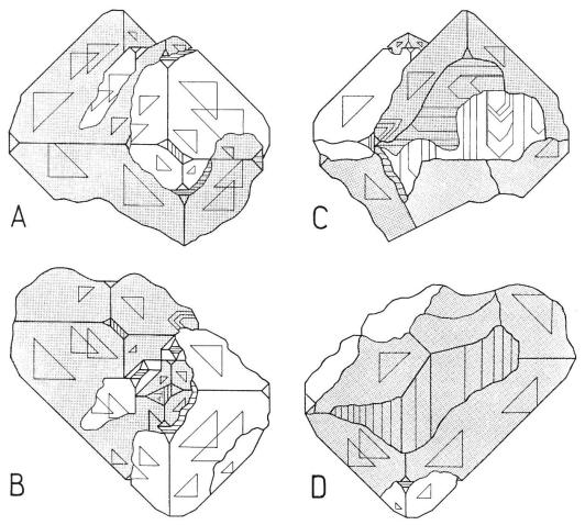
Fig. 10. Geminato ottaedrico di pirite in proiezione ortogonale su 100 (A), 001 (B), \(\bar{1}00\) (C), e 00\(\bar{1}\) (D). Sono visibili anche piccole facce di \(\{100\}\) (striate) e di \(\{210\}\) (triangoli isosceli e triangoli rettangoli isosceli). Nelle figure C e D queste due forme compaiono con facce grandi, l'una succedendosi all'altra. Sono disegnate in grigio le parti appartenenti al secondo individuo, eccettuata nella fig. B la parte circoscritta a destra davanti.
