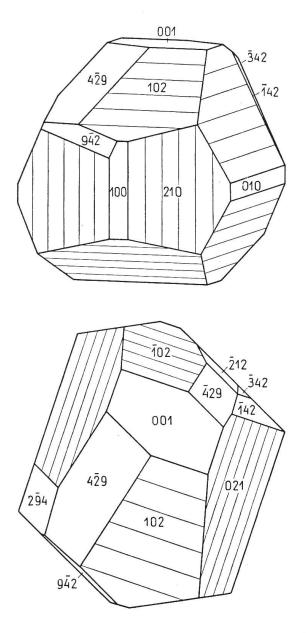
Fig. 12. Pirite della Tarentaise con quattro facce caratteristiche di {942} ed una piccolissima faccia di ciascuna delle forme {421}, {423} e {221}. Dalla proiezione su 001 disegnata sotto si può valutare come il cristallo sia sproporzionato.
