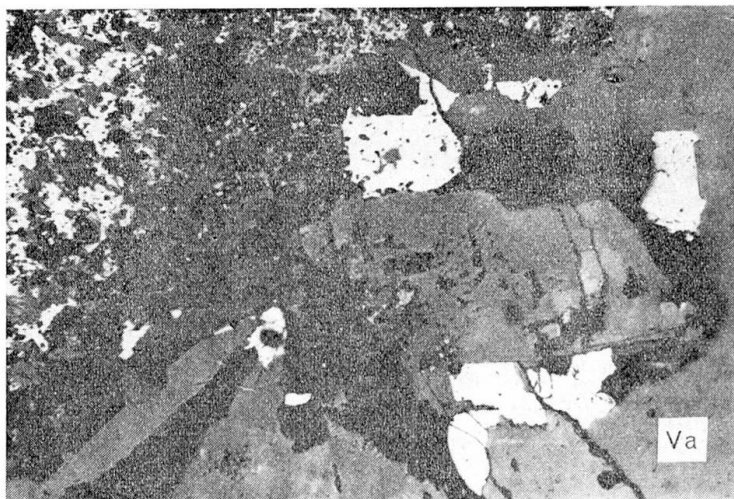
Photo 4. Sulfoantimoniure de Tl. Va = valentinite. G = 340\times , soit 30 microns/cm. Lumière naturelle, immersion.
