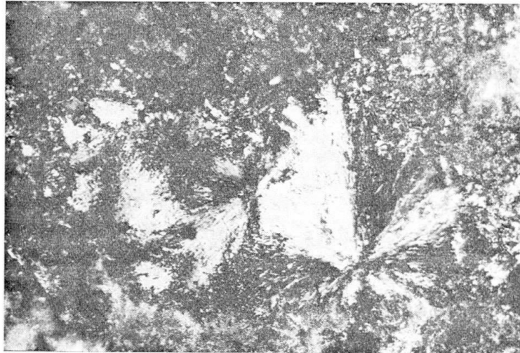
Photo 2. Même plage que photo 1. Lumière polarisée et analysée. Objectif à immersion. G = 500 ×, soit 20 microns/cm.
