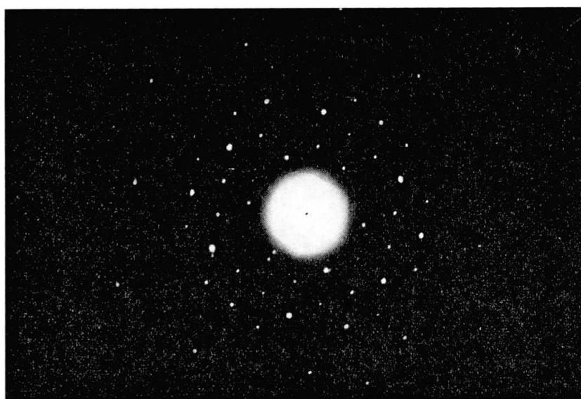
Fig. 6. Cliché de diffraction électronique de la lithiophorite, obtenu par un faisceau normal au clivage (001).
