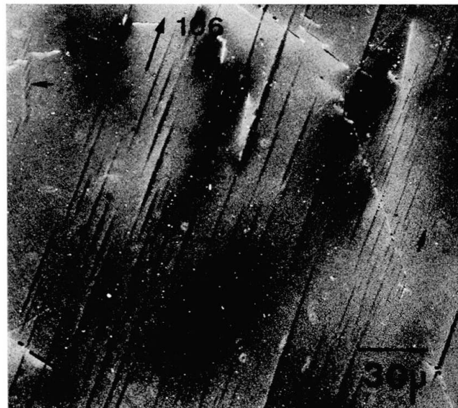
Fig. 6. Mikroklin-Perthit L_{35} (Ravensthorpe, Australien). Spindelförmige kryptoperthitische Na-Feldspatausscheidungen in Richtung [106] im Photo-EEM (vgl. Fig. 5, C). Beachtenswert sind auch die sehr feinen Ausscheidungen (kleine Pfeile).
