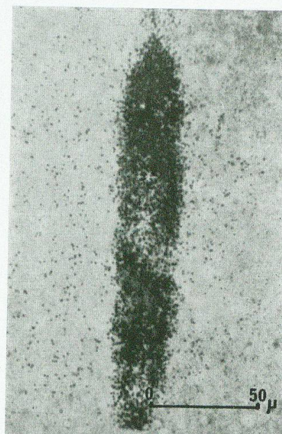
Fig. 8. Balayage à la sonde électronique raie K_{\alpha} Zr. Le pointillé noir dense correspond à la distribution du zirconium, la matrice quartzreuse est en grisé.
