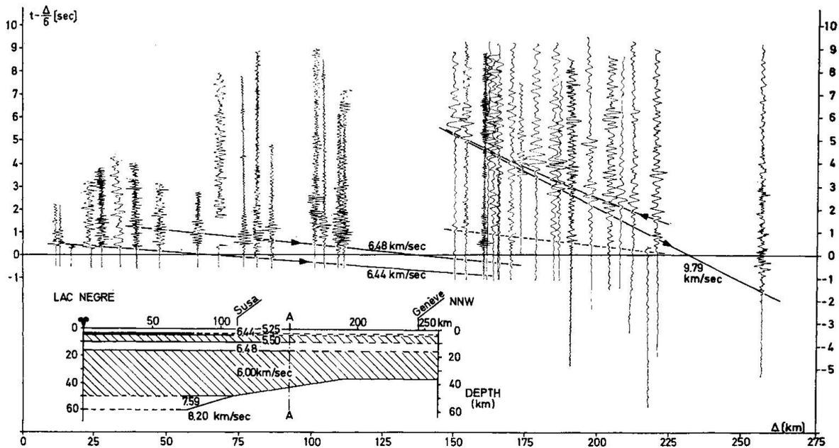
Fig. 2. Seismogramm-Montage und daraus abgeleiteter Krustenschnitt für das Lac Nègre-NNW-Profil (1958).
