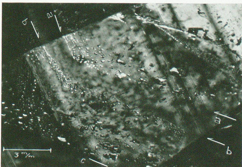
Fig. 16. Lagenweise angereicherte Flüssigkeitseinschlüsse a, b und c. Liegen Translationsflächen parallel. (Normales Rhomboeder.) Translationszone in Quarz (rechts) der Fig. 15.
