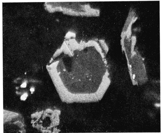
Fig. 5. \text{Cu}_5\text{FeS}_6 in KCl-LiCl-Schmelze. 6 Tage \sim 420^\circ\text{C} . Parallelorientierte Umwachsung von \text{Cu}_5\text{FeS}_6 um CuS. Vergr. 550\times , Ölimmersion.
