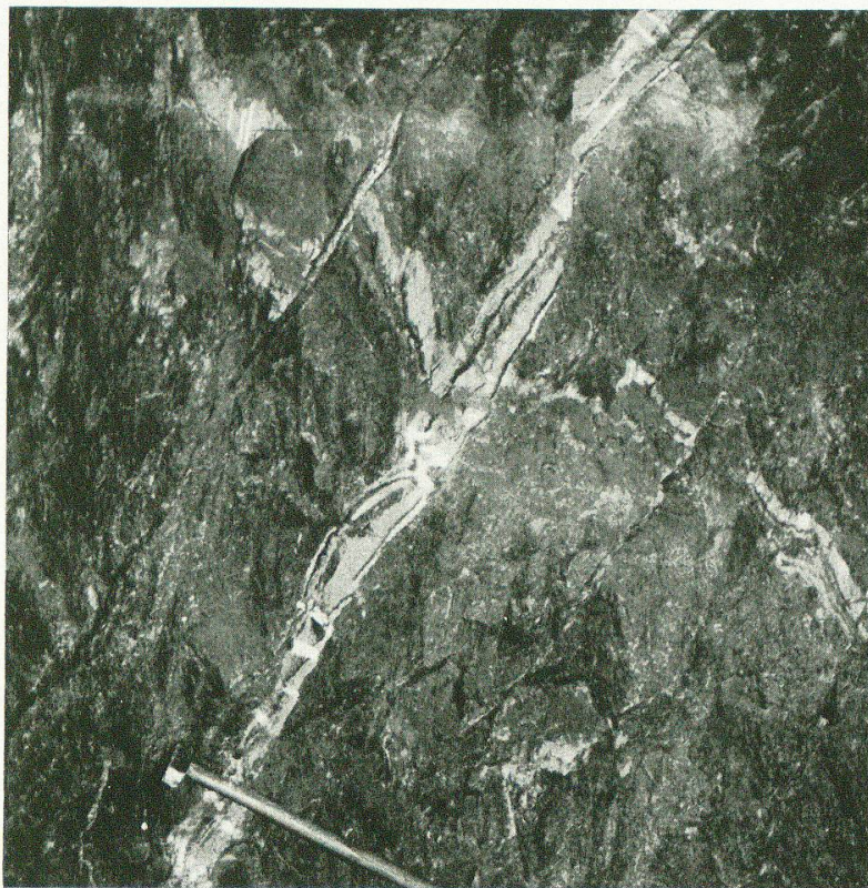
Abb. 2. Turmalin-Aplitgänge (von rechts oben nach links unten verlaufend) in Biotitschiefer des Altkristallins, ältere Quarzadern (hell) durchsetzend. — Stollen Rotlaur nach Trift, m 790 (talseitiger Stoss).
