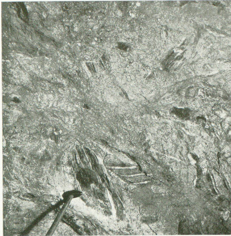
Abb. 3. Innertkirchnergranit, porphyrtig, mit Amphibolitscholle (direkt ob Hammer) und verschiedenen Biotitgneisschollen (gebändert, meist scharf gegen Granit begrenzt). — Stollen Schaftelen nach Steinwasser, m 1025 („Bahnhof“, Talseite).
