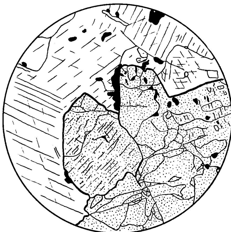
Fig. 2. Dünnschliffbild von Calcit-Datolithaggregat, punktiert Datolith, schraffiert Calcit
