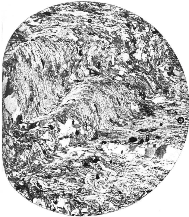
Phot. 1 Casannaschiefer Baicolliou Fältelungsbewegung in der Hauptsache älter als Kristallisation Anordnung der Muskovite als Abbildungs- Kristallisation der vorangegangenen Fältelung Dünnschliff 33 ×
