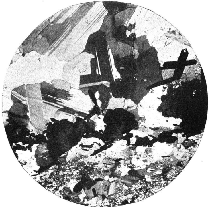
Phot. 2 Aplitischer Pegmatit, Rousson (Val d'Anniviers) Unten Zug von serizitisierten Feldspäten, parallel- struiert; oben regellos struierte Partie von wasserklaren Albiten Ganz schwarz = Eisenglanz Dünnschliff 33 ×
