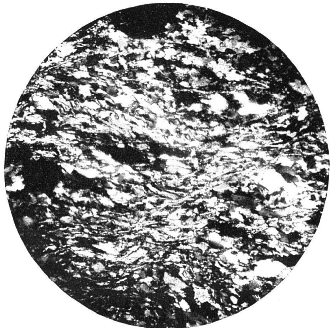
Phot. 19 Quarzreiches Nebengestein des Ganges von Baicolliou In der Horizontalen parallel angeordnete Quarze mit ausgesprochen undulöser Auslöschung. Schief zu dieser Richtung (rechts oben — links unten) Anordnung der Serizite. Transversalverschiebung jünger als Quarze. Dünnschliff 33 ×
