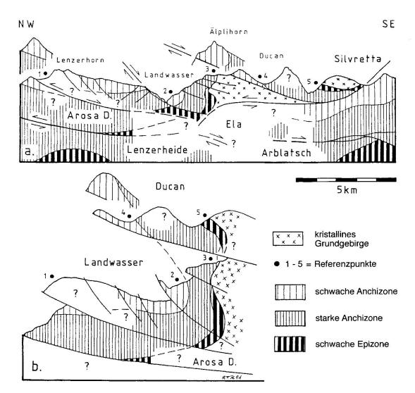
Abb. 9 a) Das Diagenese-Metamorphose-Muster im Profil durch den Deckenbau Mittelbündens. Deckenüberschiebungen und Abschiebungen stören die Verteilung der einzelnen Zonen.
