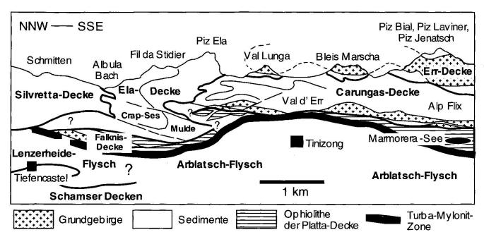
Abb. 13a Schematisches Sammelprofil durch das Oberhalbstein (vgl. Abb. 2, Gebiet C). Tektonische Übersichtsskizze.
