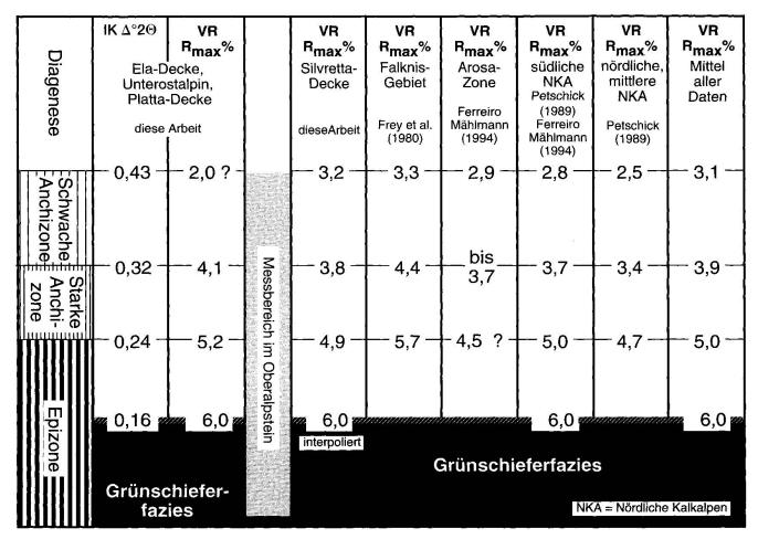
Abb. 17 Abgrenzung von Diagenese-, Anchi- und Epizone bezogen auf die Illit-"Kristallinität" als Kübler-Index (IK  $\Delta^{\circ}2\Theta$ ) und Gegenüberstellung mit der Vitrinitreflexion als VR  $R_{max}$ %. Für verschiedene alpine Gebiete können abweichende Vitrinitreflexions-Grenzwerte für gleiche Illit-"Kristallinitäts"-Zonen festgestellt werden.
