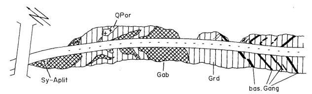
Abb. 6 Profil des Nordteils der Umfahrungsstrasse von Pontresina (Koord. 789.100/151.730), Massstab 1: 2000, dreifach überhöht: Der Granodiorit dringt in den Gabbro ein und wird von einem Quarzporphyrgang, granitischen und syenitischen Apliten sowie basischen Gängen durchschlagen.
