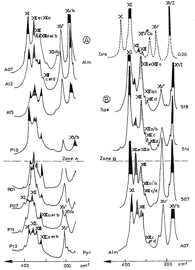
Fig.~7 Allure des spectres Raman, entre  $450-120~{\rm cm}^{-1}$ , pour les mêmes échantillons que ceux des figures 3 et 5, et repérage des bandes de XI à XVI.
