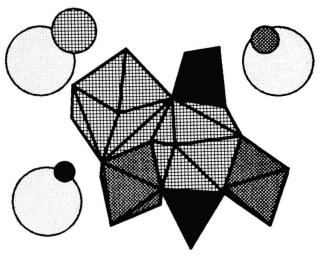
Fig. 1 Portion de la structure du grenat  $X_3Y_2Z_3O_{12}$ . Chaque oxygène est lié à un tétraèdre  $ZO_4$ , à un octaèdre  $YO_6$  et à deux dodécaèdres  $XO_8$ . Comparés au volume de l'oxygène les volumes de  $Si^{4+}$ ,  $Al^{3+}$  et  $Mg^{2+}$  sont représentés respectivement en noir, ponctué et hachuré, le tout avec la même échelle et les mêmes motifs que leurs polyèdres respectifs.
