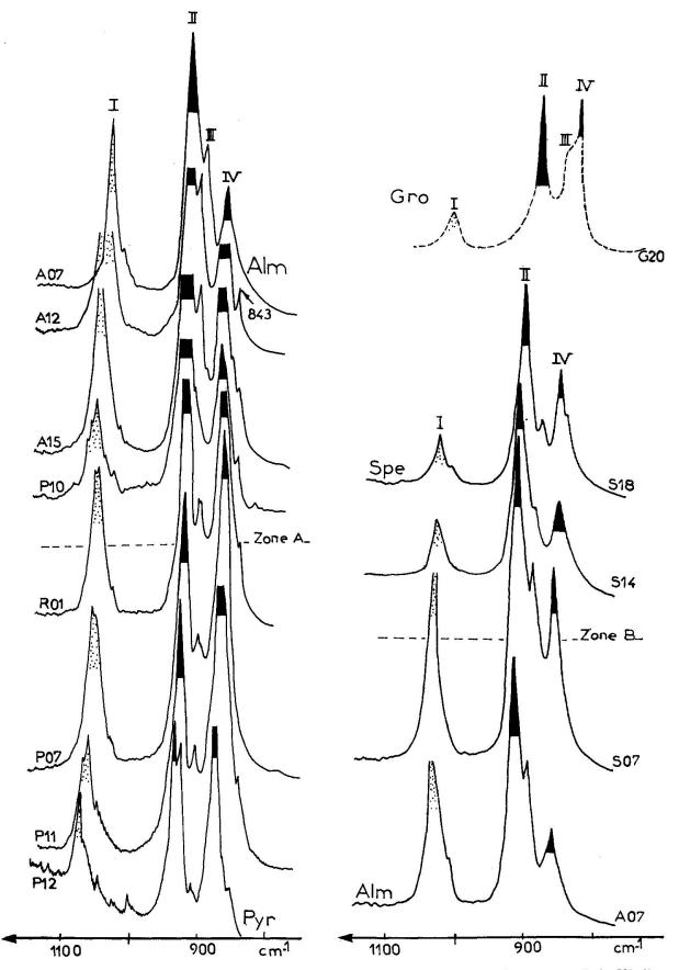
Fig. 3 Allure des spectres Raman, entre 1100 et 750 cm<sup>-1</sup>, de quelques grenats alumineux naturels (< 5% d'ugrandite) le long des séries Pyr-Alm et Alm-Spe et pour un Gro (G20). Les bandes Raman répertoriées sont numérotées de I à IV vers l'excitatrice (Tab. 2).
