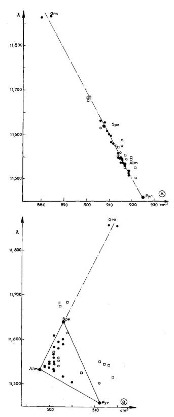
Fig. 10 Pour des grenats alumineux naturels, le paramètre «a» (en Å) de la maille, calculée par diffraction X sur poudre, est donné en fonction du nombre d'onde: (A) pour la bande II, (B) pour la bande VIII. Les symboles vides représentent des compositions de grenats alumineux naturels plus riches en And, Gro ou Ouv. Le pôle Gro est représenté par les échantillons G20 et SO4 étudiés dans PINET et SMITH (1993).
