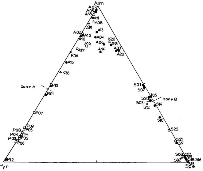
Fig. 2 Localisation dans un diagramme triangulaire (Pyr-Alm-Spe) des grenats alumineux naturels étudiés en microspectrométrie Raman:  $\bullet$  < 5% de (Gro + And + Ouv);  $\bigcirc$  entre 5 et 10%;  $\square$  entre 10 et 20%; et  $\triangle$  > 20% (Tab. 1). Dans ce diagramme (et Figs 3, 5 et 7) «zone A» et «zone B» signalent les compositions à partir desquelles les spectres Raman présentent des changements significatifs d'intensités de certaines de leurs bandes.
