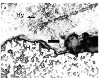
Fig.~2 Hetaerolite granulaire (H) et hydrohetaerolite aciculaire (Hy). Lumière naturelle réfléchie; le tiret = 50 μm. a) l'hetaerolite tend à être remplacée par l'hydrohetaerolite; b) de l'hetaerolite, très finement grenue, se forme aux dépens de l'hydrohetaerolite, selon le sens de la flèche. Cette transformation s'effectue à la périphérie d'une concrétion d'hetaerolite.
