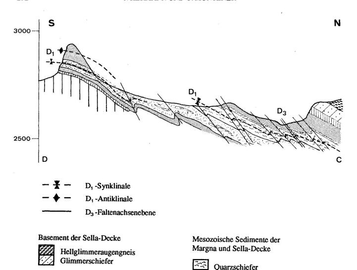
Abb. 4 N-S-Profil durch die Tremoggia-Mulde im Kessel des Scerscen inferiore, senkrecht zu  $FA_3$ . Südvergente  $D_3$ -Falten überprägen die Sedimentsynklinale. Die Faltenachsenflächen der dritten Deformation werden von  $D_6$  verstellt. (Profilspur siehe Abb. 2.)
