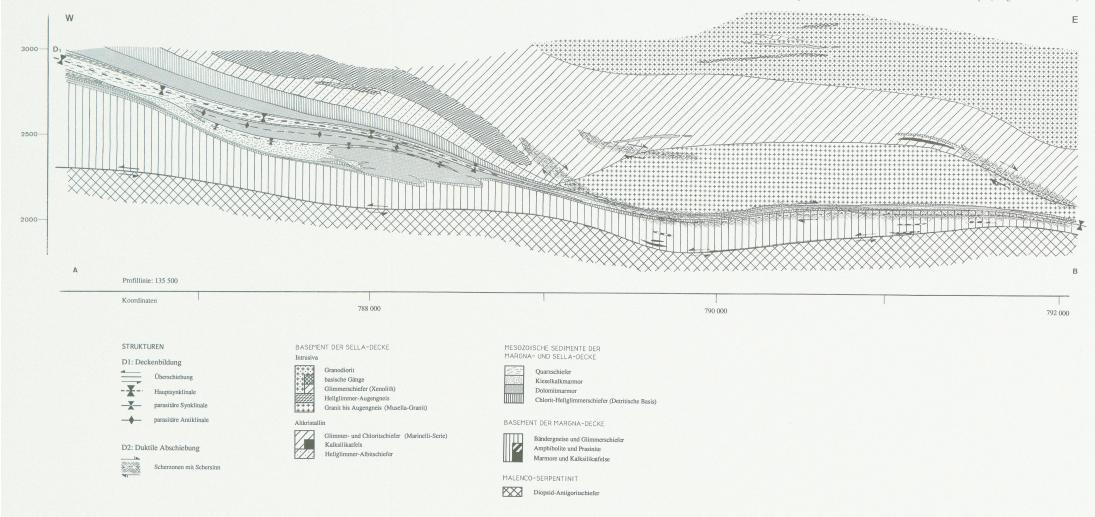
$Tafel\ 1$  E-W-Profil durch die Margna- und die Sella-Decke. Profilspur siehe Abb. 2. Neben den Lithologien sind die wichtigsten Strukturen der Deckenbildung (D<sub>1</sub>) und der duktilen Abschiebung (D<sub>2</sub>) eingezeichnet.
