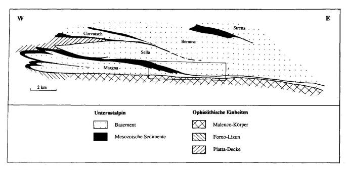
Abb. 3 Stark vereinfachtes E-W-Profil des unterostalpinen Deckenstapels (Daten von Staub, 1946; Liniger und Guntli, 1988; Spillmann, 1989; Spillmann und Büchl, im Druck). Der Deckentrenner zwischen Sella- und Bernina-Decke verschwindet im Osten. Die Margna-Decke wird im Westen von ophiolithischen Einheiten unter- und überlagert. Im untersuchten Gebiet (eingerahmt, Detailprofil siehe Tafel 1) dünnt sowohl die Margna-Decke als auch die Tremoggia-Mulde aus.
