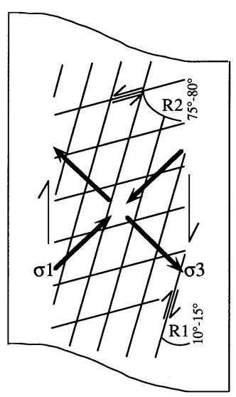
Abb. 5 Schematische Darstellung der Störungszone mit den synthetischen (R1) und antithetischen (R2) Riedelbrüchen nach Ramsay und Huber (1987); σ1 ist die Richtung der maximalen Kompression und σ3 die Richtung der maximalen Extension.
