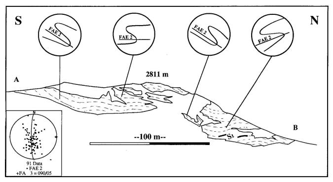
Abb. 4 Blick von der Vedretta di Pizzo Scalino nach Westen zeigt eine sanfte Wellung der Schieferung der ersten Deformationsphase (S<sub>1</sub>) durch die dritte Phase mit gleichzeitiger Verfaltung der Parasitärfalten der zweiten Phase. Der Stereoplot (untere Halbkugel) der Faltenachsenebenen der zweiten Phase (FAE 2) zeigt die Verfaltung um die Faltenachse der dritten Phase (FA 3).
