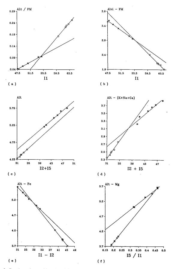
Fig. 2 Représentation graphique des relations entre d'une part, les combinaisons de variables  $I_1$ ,  $I_2$  et  $I_5$  et d'autre part, les substitutions de cations à Al' et  $A^{vi}$ . Les régressions linéaires des tableaux 3 et 4 sont représentées par les droites en trait plein. L'ordre des échantillons est celui du tableau 2.
