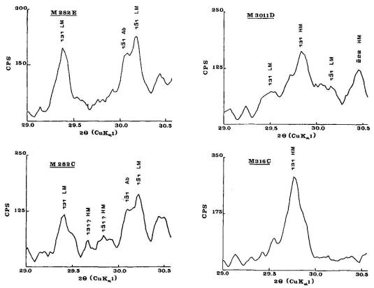
Fig. 11 Fenêtres 20 comprises entre 29.0° et 30.5° de quatre spectres typiques avec et sans phases subordonnées. Les échantillons M282E et M316C possèdent une phase structurale unique, respectivement de low microcline et de high microcline. Dans l'échantillon M282C apparaît, en plus des pics du low microcline dominant, le pic 131 du high microcline. L'échantillon M3011D présente le cas inverse avec high microcline dominant et low microcline subordonné.
