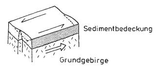
Abb. 7 Beziehung zwischen Grund- und Deckgebirge unter der Einwirkung einer Blattverschiebung im Grundgebirge. Ausgehend von der Basis der Sedimentbedeckung nimmt der horizontale Versetzungsbetrag nach oben ab. Im Bereich der heutigen Oberfläche erfolgt eine einfache Scherung. Die Kraft wird durch die relative Verschiebung der undeformierten Randbereiche der Sedimentbedeckung übertragen.
