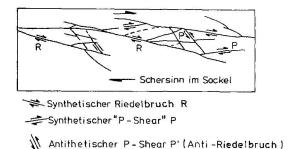
Abb. 6b Beobachtete Bruchgeometrie in Scherexperiment mit Sanden (nach NAYLOR et al., 1986).
