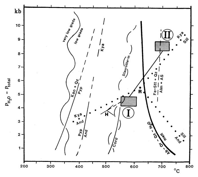
Abb. 6 Druck, Temperatur-Diagramm aus Winkler (1979). Tripelpunkt nach Richardson (1969) und Holdaway (1971). I Bildung von Andalusit und Staurolith; II Zerfall von Staurolith
